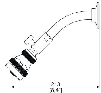
Incluye **válvula de control** que regula el volumen de agua. Restringe el chorro de agua mientras te enjabonas. No se pierde la mezcla de agua. Presión mínima requerida 0.20 kg/cm<sup>2</sup> Consumo máximo de agua: 10 L/min
