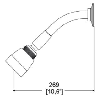
Incluye **válvula de control** que regula el volumen de agua. Restringe el chorro de agua mientras te enjabonas. No se pierde la mezcla de agua. Presión mínima requerida 0.20 kg/cm<sup>2</sup> Consumo máximo de agua: 10 L/min
